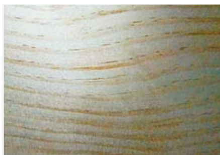
Ugyanaz a fa bordás profilú szerszámmal gyalulva, majd simító gyalulást kapott, kiváló felület
