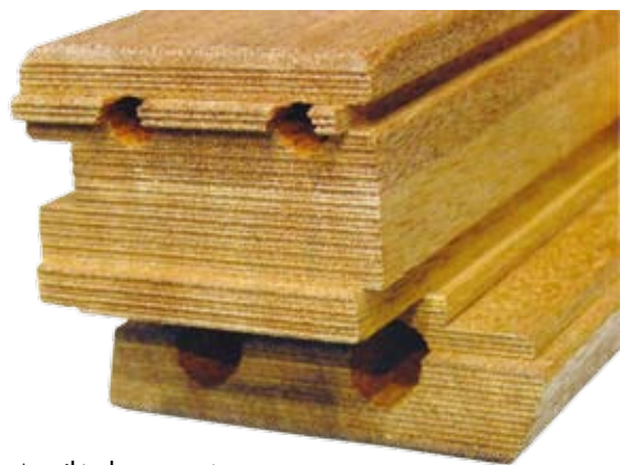
A szilárd ragasztóréteg alapja: a bordázott felület meghatározza a ragasztóréteg mennyiségét
