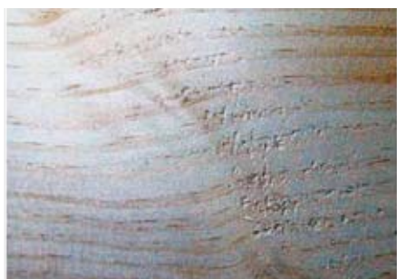
Ferdészálú faanyag hagyományos gyalulás után: a károsodás már nem tüntethető el simító gyalulással
