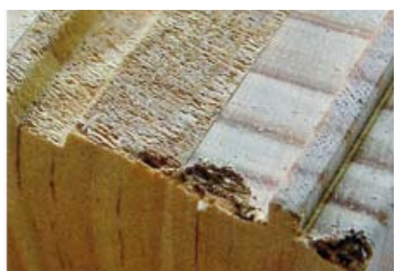
Hagyományos keresztirányú megmunkálás. Kontraprofilok jellegzetes helyrehozhatatlan szálkiszakadással
