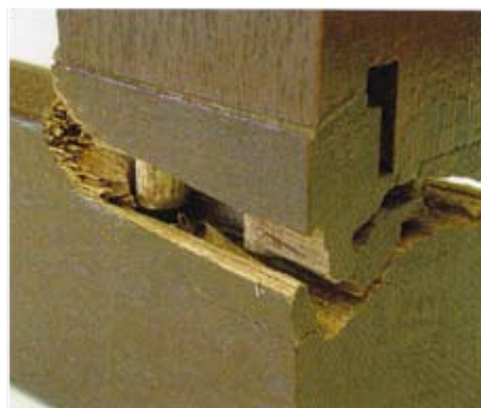
A bordás profillal készült sarokkötés törésekor a faanyag roncsolódik, maga a ragasztóréteg érintetlen
