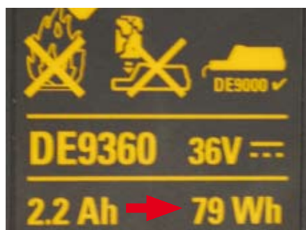
Az újabb akkukon már a tárolt energia nagysága is megtalálható: 79 Wh
