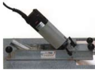
Az AK-SF gyorsfordulatú maró ferde oldalú mosogatók beépítésének speciális gépe
