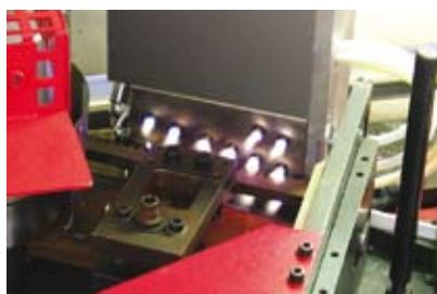
A nagyfrekvenciás generátor által termelt áram a fúvókán kiáramló gáz erős ionizációját okozza, amelyből létrejön a plazma
