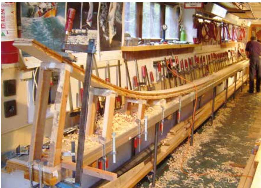
Hajógerinc az építőágyon
