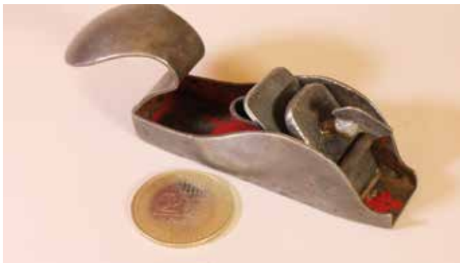
Vaslemezről hajtogatott és hegesztett minigyaluca
