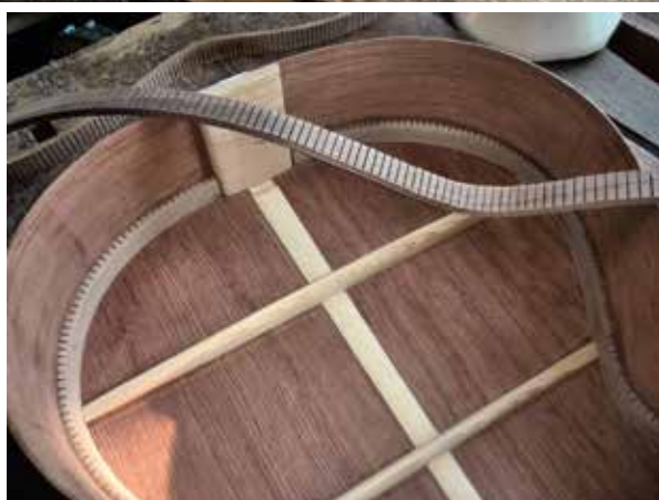
Készülő gitár, oldallap hajlítása sablonban, ragasztóléc a hát és oldallap összeragasztásához
