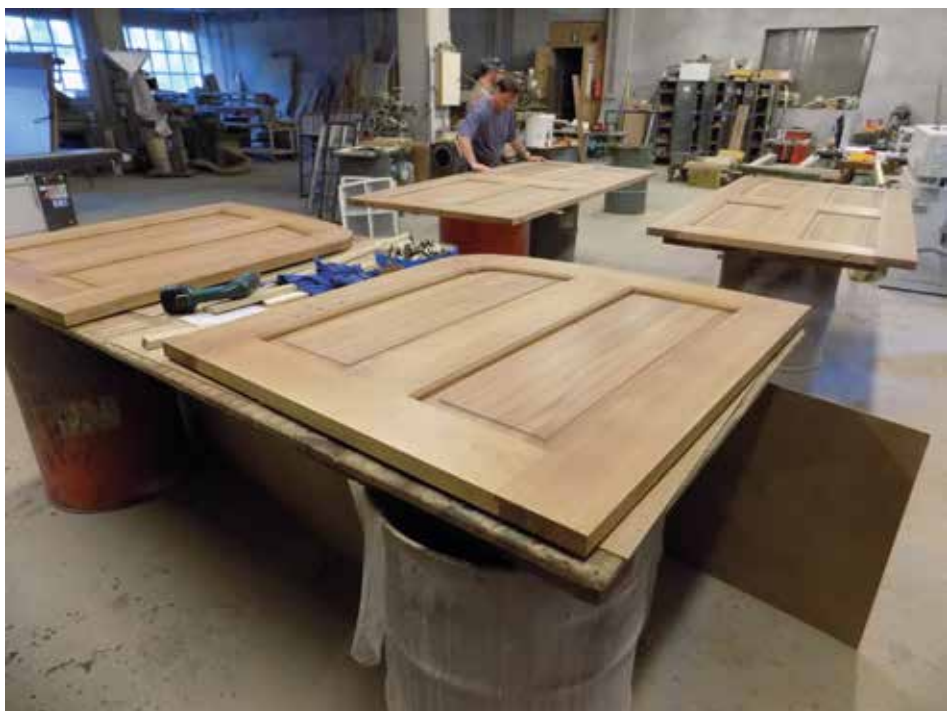
Műemléki nyílászáró, közvetlenül fűrészáruból, hosszanti toldás nélkül gyártva (A szerző saját felvétele.)
