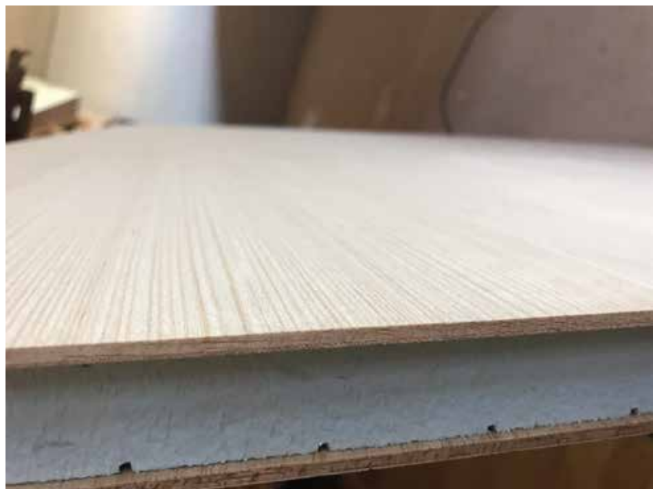
Magas hőszigetelő képességű szendvicspanel (borovi-fenyő.hu)
