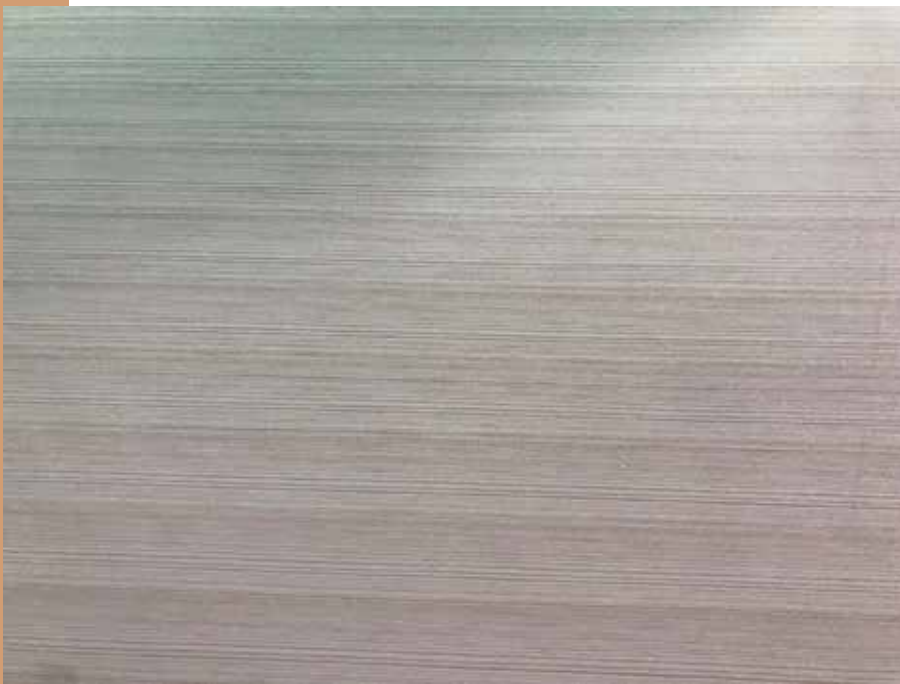
A kétszer késelt borovi rétegelt lemez homogén felületet ad (borovi-fenyő.hu)
