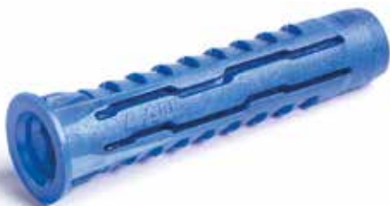
Az univerzális műanyag tiplik rugalmas palástjai az üregben szétnyílnak biztosítják a rögzítéshez szükséges erőt
