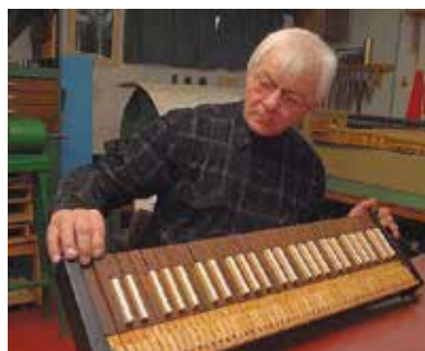
Műszaki értelemben a különféle orgonák elkészülhetnek a műhelyben, de a sípok hangzását a helyszíni akusztikához állítja be
