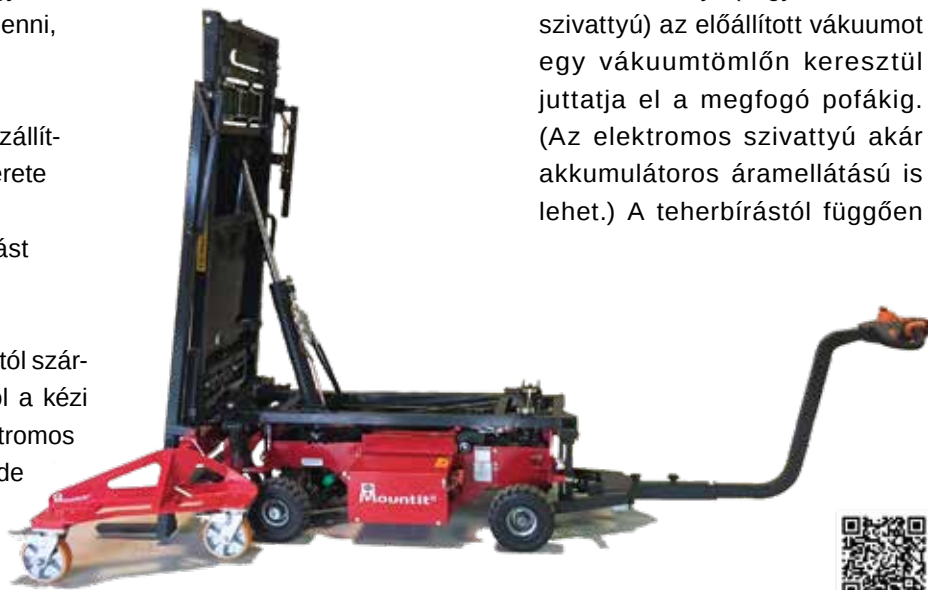
Az akkumulátoros szerkezet emelésre, mozgatásra, rakatforgatásra is alkalmas
