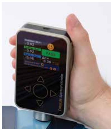
Spektrofotométerrel színt azonosíthatunk, ellenőrizhetünk, továbbá színeltérést mérhetünk
