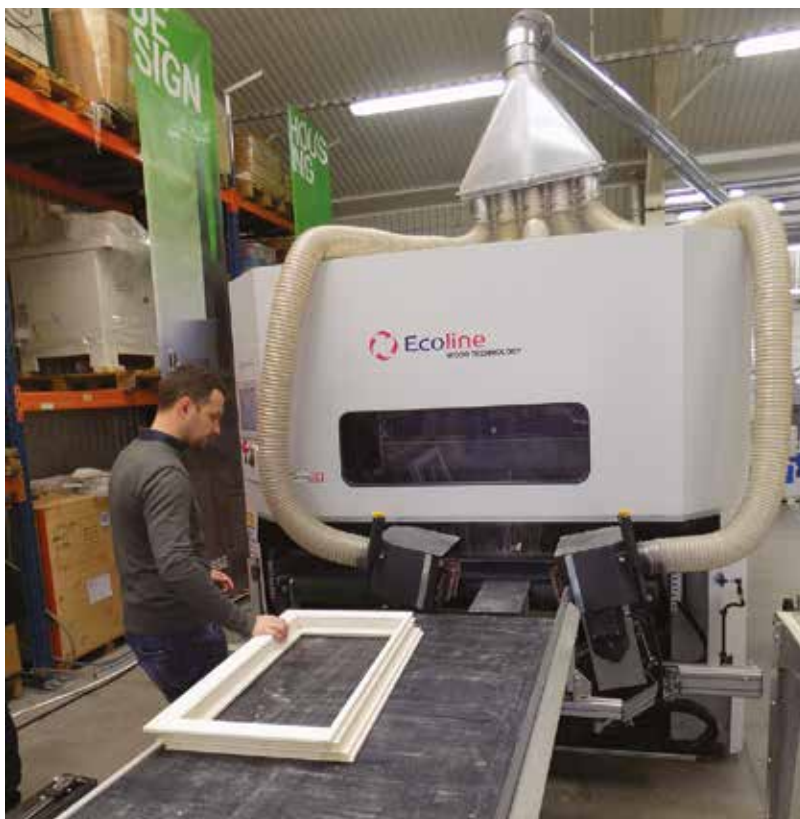
Speciális ablakkeret-csiszoló, ami külső és belső élek megmunkálására is képes
