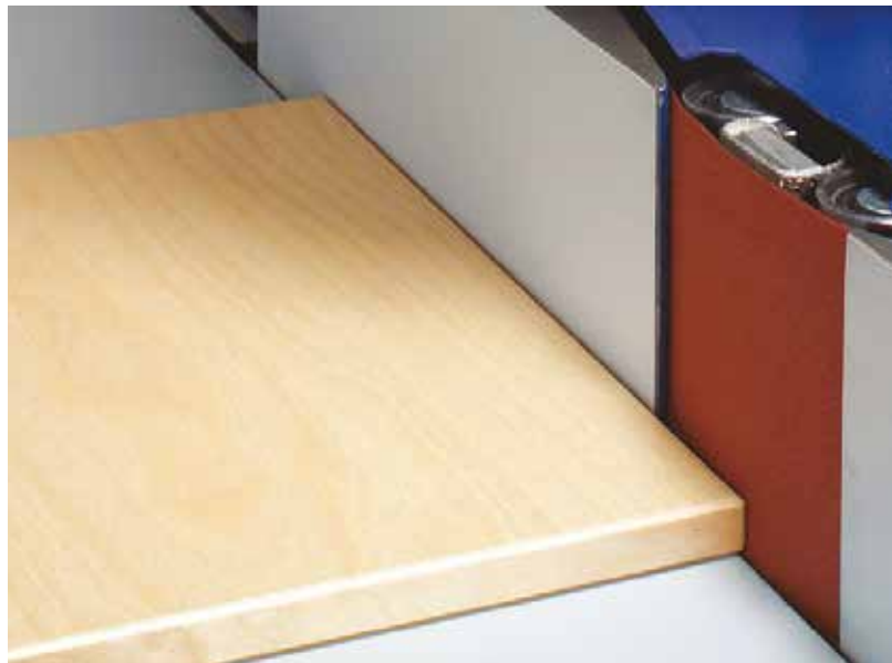
Ez az élcsiszoló gép nagy méretű és fokozatmentesen dönthető asztallal rendelkezik, ahol az oszcillációs mozgásról külön motoregység gondoskodik
