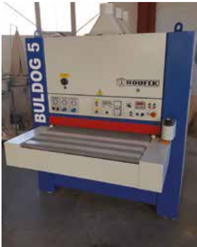
A kontaktcsiszoló gép robusztus szerkezet, ami többféle opcióval és számos különböző megmunkálási szélességgel rendelhető
