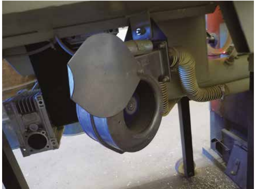
A ventilátor fordulatszáma igény szerint szabályozható, a begyűjtés idejére pedig elzárható.
