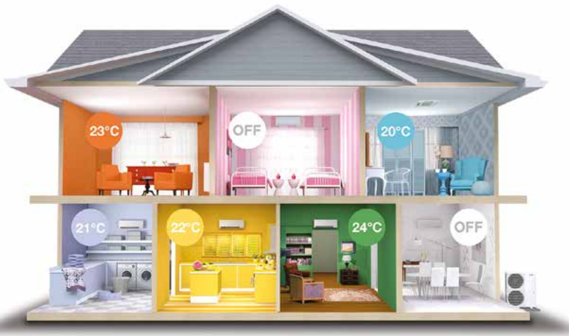
A többcsatornás VRF klímarendszer egyszerre hűtésre és fűtésre is képes
