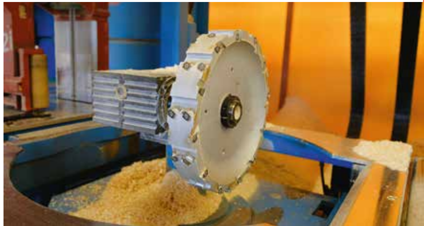
Castor Optimo: a kevesebb forgácsolási ellenállás lehetővé teszi azonos előtolásnál a nagyobb forgácsolási teljesítményt
