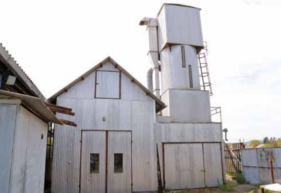
Kültéri silós elszívó, ami képes a téli fűtött levegő visszatáplálására
