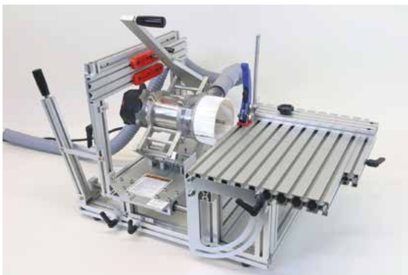
A másolómaró, azaz pantorouter gyári kivitelben is megvásárolható
