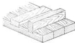
8. ábra: Lapmerekítés fekvő és álló hevederléccsel
