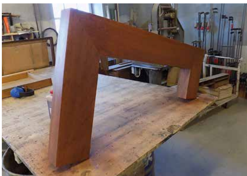
Tömör tölgyfa kandallópárkány, műhelyben készre gyártva, pácolt-lakkozott kivitelben (Fa-Míves Kft.)
