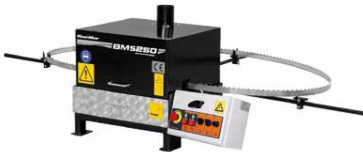
Ez a Wood Mizer élező 4 m-es szalagot 5 perc alatt élez meg. (woodmizer.ca)
