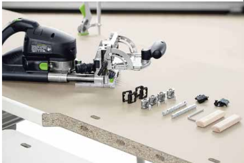
A Dominózóval sajnos csak 30 mm-nél vastagabb anyagok fogathatóak össze
