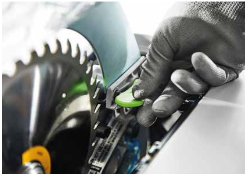
A technológia központi eleme egy patron, mely egy rugó segítségével egy alumíniumtömböt lök a fűrészlapnak, ha az üzemelés közben érintkezésbe kerül az emberi bőrrel.
