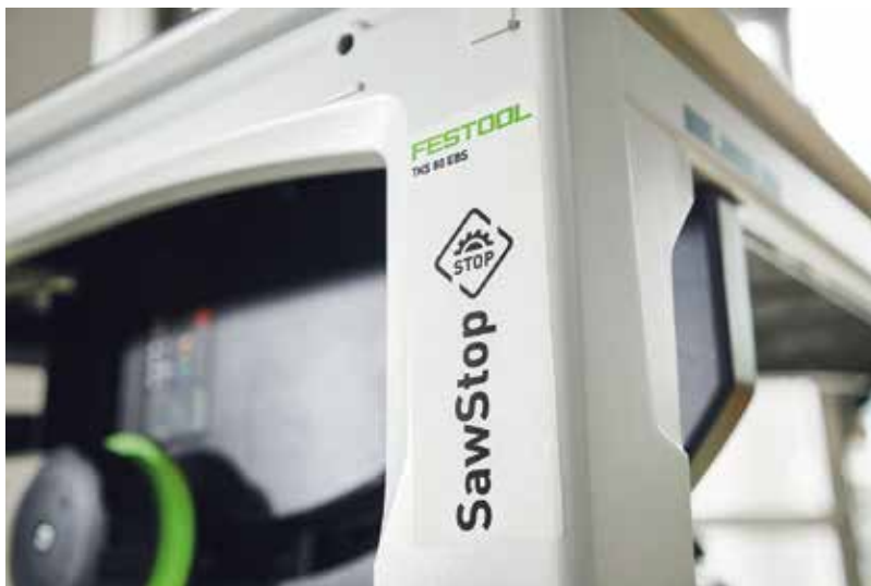
Az asztali körfűrészbe beépített új SawStop-technológia fokozott védelmet nyújt a súlyos munkahelyi balesetek ellen.
