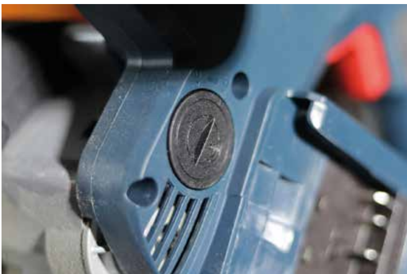
A fekete „tányér” alatt lapul a kommunikációs egység.
