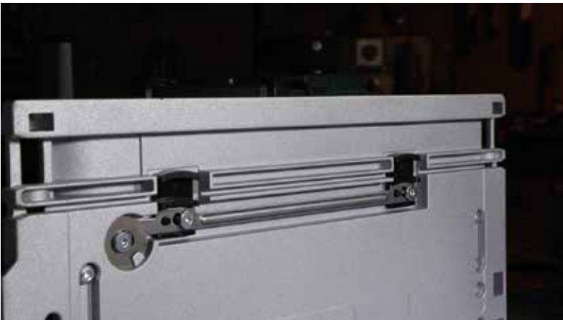
A piros gomb benyomásával a szögállítás mértéke kiterjeszhető -1^\circ és +47^\circ közé.
