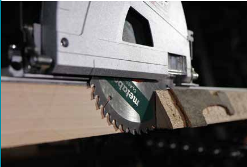
52 mm vastagságú bükk szélezése a gyári 42 fogas lappal.
