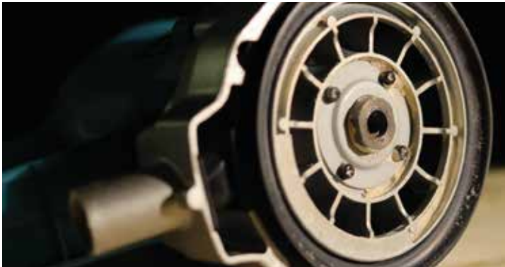
3 milliméteres excenterlöket pormentes csapágyakkal
