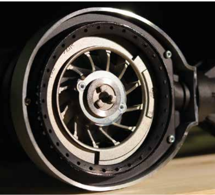
A tömítőgyűrűn található nyílások fokozzák az áramlást és jobb elszívást tesznek lehetővé.
