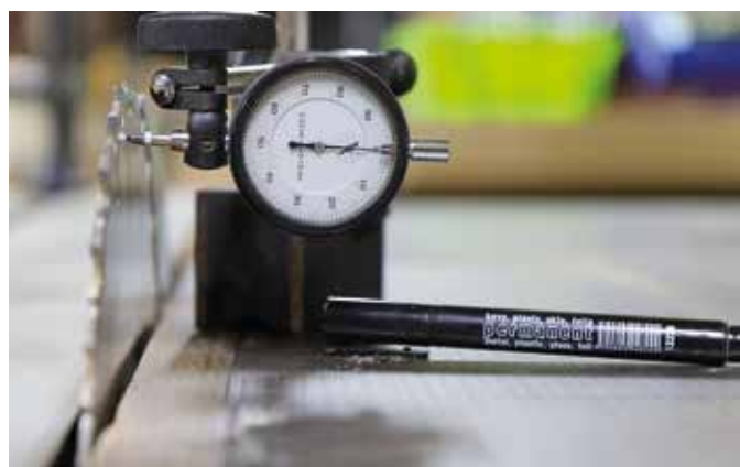
Kiinduló és köztes állapot. 6 század az ütése a lapnak. A kontrollmérés során kiderült, hogy a lapot kell kezelésbe venni.
