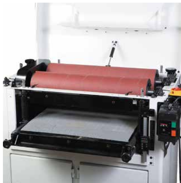
A magassági állítással az asztalt mozgatjuk. Igaz, az állítás manuális.
