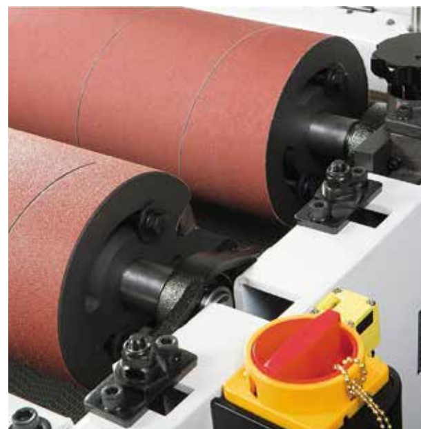
Egy menetben az elő- és végcsiszolás. Ezáltal termelékenyebb a gép.
