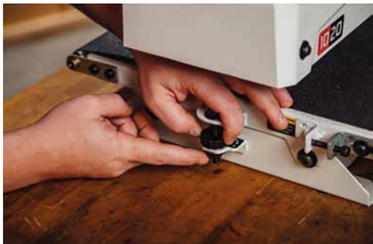
Az asztalnál lévő kis karral a párhuzamosság finomhangolható. Jól látszanak a kis átmérőjű leszorító hengerek. Az olcsó gépeken a rugócsere jobbá teszi a gép tulajdonságait.
