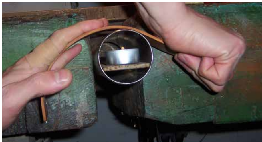
A káva hajlítása felhevített acélcsövön
