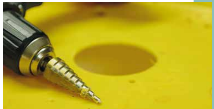
Furatok kialakítása. A vékony műanyagot lépcsősúróval meglepetések nélkül fúrhatjuk meg
