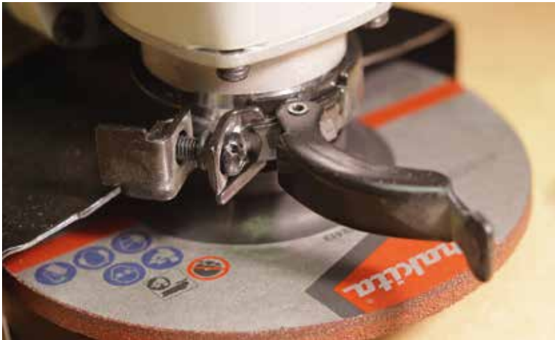
Régi ismerős a jól bevált excenteres védőburkolat.
