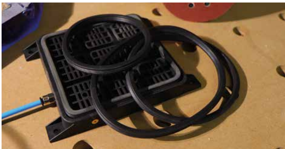
A gumialátétek cserélhetőek, így a tapadófelületet az adott munkadarab paramétereirez lehet igazítani.
