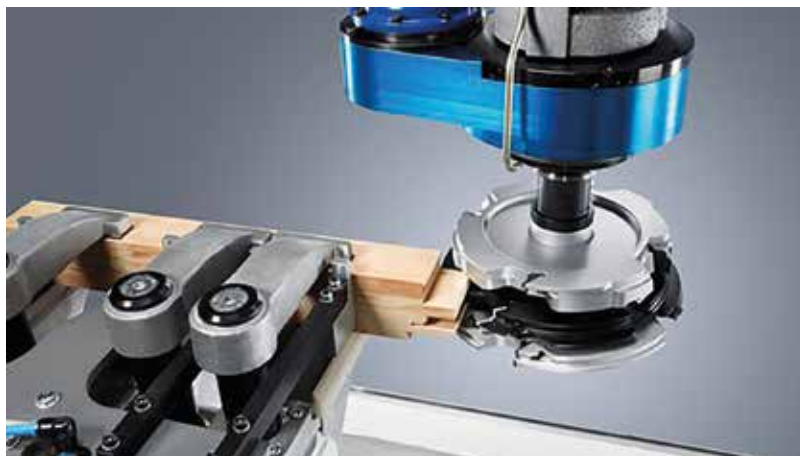
Hagyományos csapós kötés CNC-megmunkálás alkatrészben.
