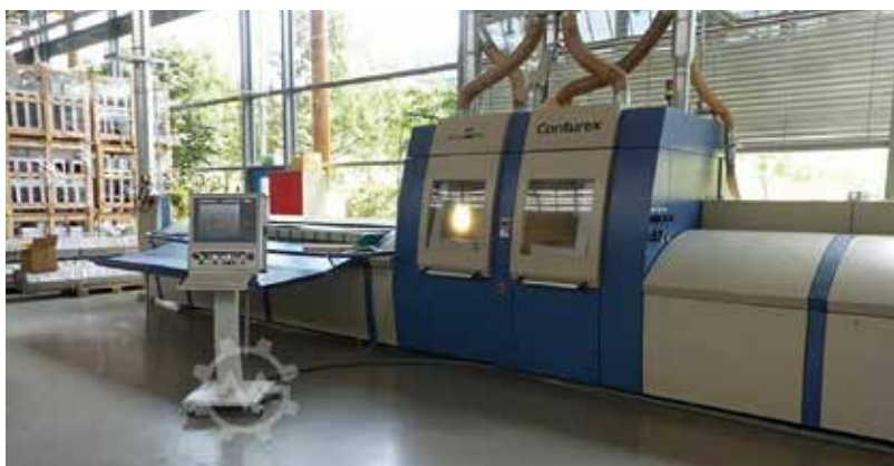
Weinig Conturex: a fríz bemegy, a szerkezetkész alkatrész kijön.
