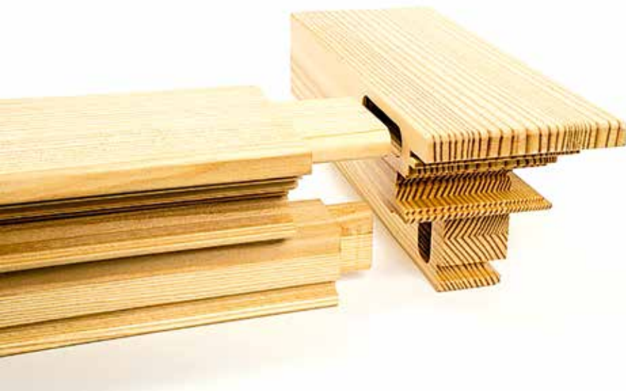
Leitz PlugTec. Szárny alkatrészek a megmunkálás végeztével.
