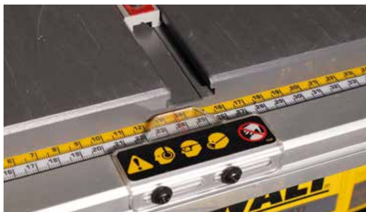
Az asztal alumíniumból készült, és egy „T” nűtot is kapott. A skála jól olvasható és a szálkereszt is állítható.
