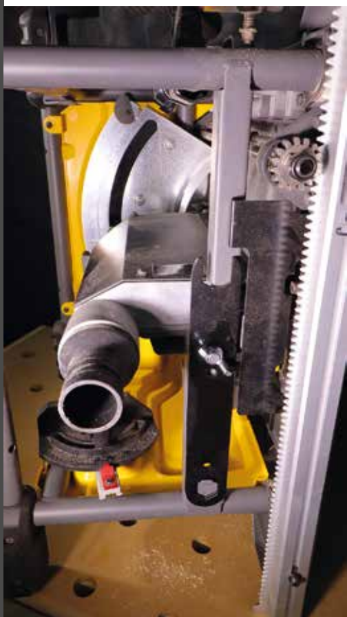
A gép hátulja. Fogasléc, evolvens fogazású fogaskerékkel, szerelőkulcsok és keresztvonalzó.
