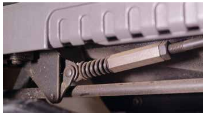
A vezetõvonalzó rögzítése egy állítható erejű, elnyúlhetetlen excenteres mechanikát kapott, acélból!
