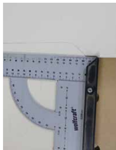
Próbaillesztés. Jól látszik a derékszögtől való eltérés és az illesztés pontossága.
