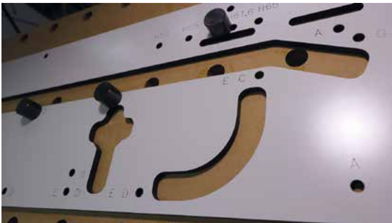
Az „E, D” és „E, C” pozíciókkal egy kellemes ívet adhatunk a munkalapok végeinek.
