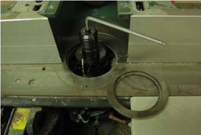
Flury fej felszerelése
