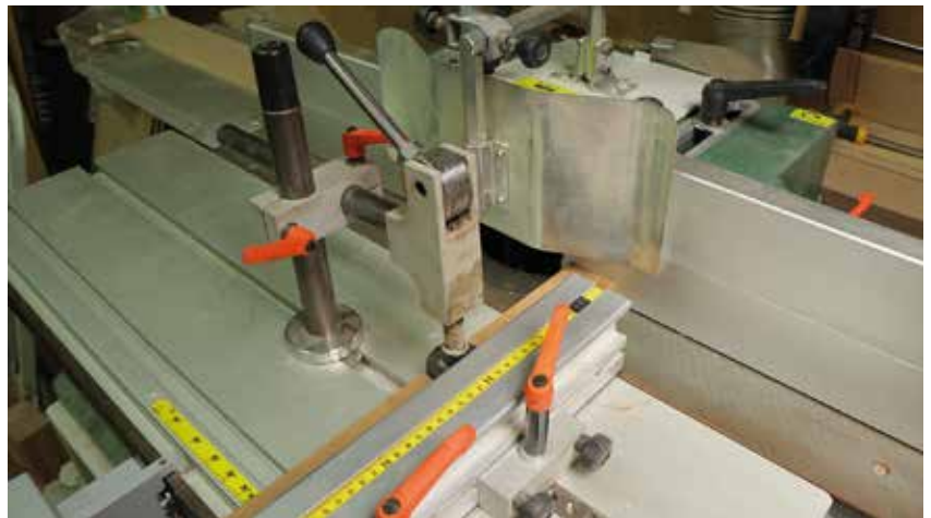
Védő- és leszorítóeszközök felhelyezése.
