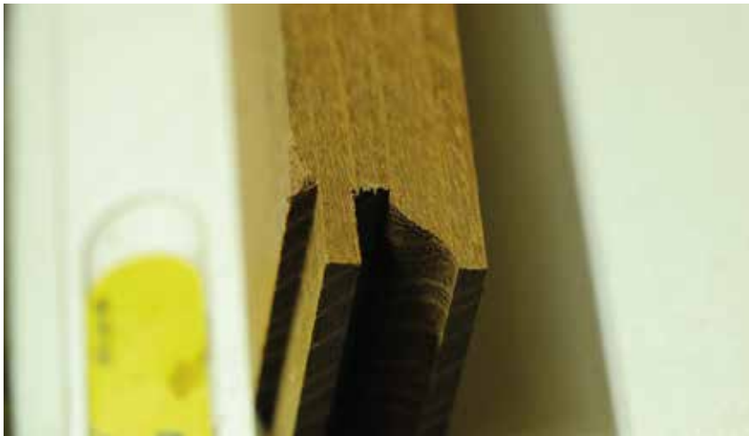
Ha mindent jól csináltunk, csapozás után ezt a profilt kapjuk.
