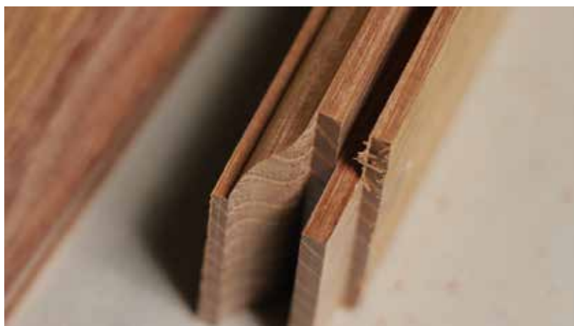
Csapozott és profilozott alkatrész.
