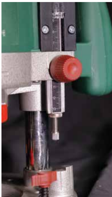
A finomállító és a revolverütköző.
