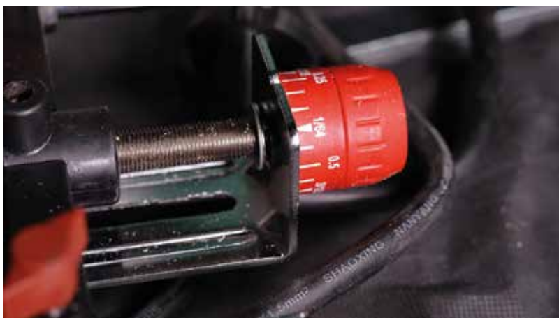
A párhuzamvezető finomállítója.
