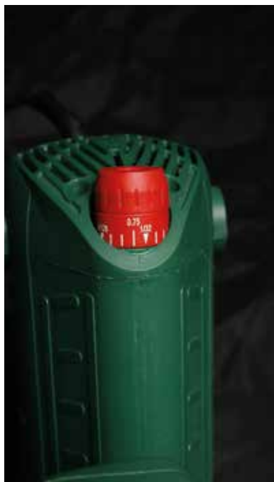
A géptest tetején trónoló finomállító.
