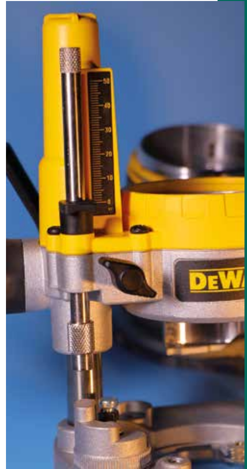
A kétkézes marótalp mélységűtközője jól használható, bár első ránézésre idegen.
