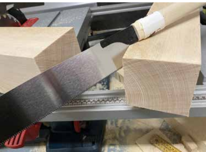
A szövetszerkezetet elnézve, nem lesznek szilárdsági problémák, és még sugármetszésű is az anyag...
