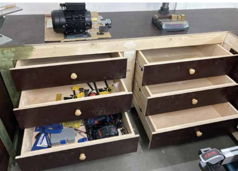
Ahol lehetett, fiókokat épített rétegelt lemezből. Fentre előnyösebb lett volna a kisebb kávamagasság.
