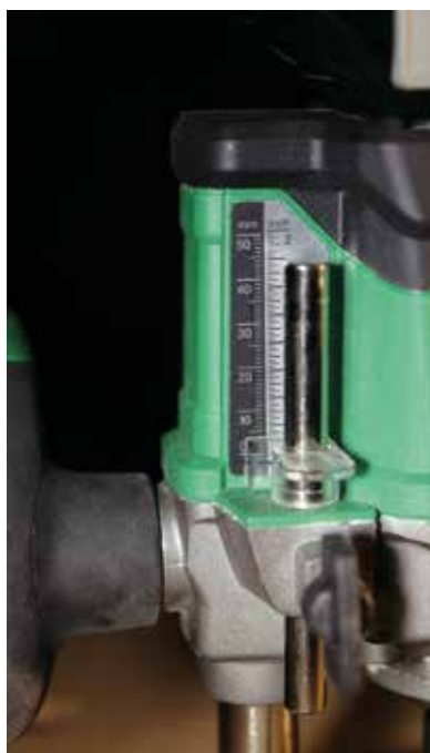
Hagyományos ütközőpálca, melyen a relatív- és finomállító is megtalálható. Jól látható a csonkolt kör alakú talp is.
