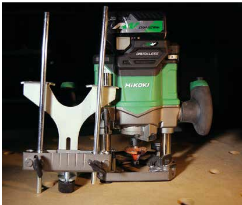
Párhuzamvezető és a gép felénk eső része – a fordulatszám-állítót a vezetőoszlop fölé helyezték.
