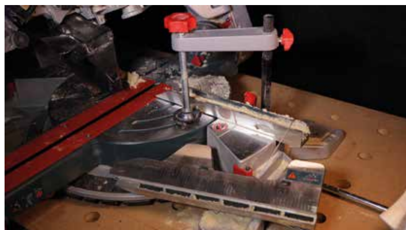
Leszerelt steller és a munkadarab-rögzítő.
