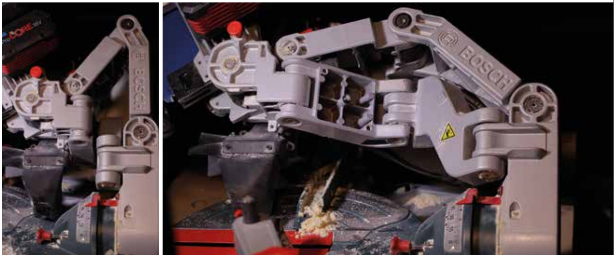
A csuklós mechanizmus összezárt és teljesen nyitott állapotban.
