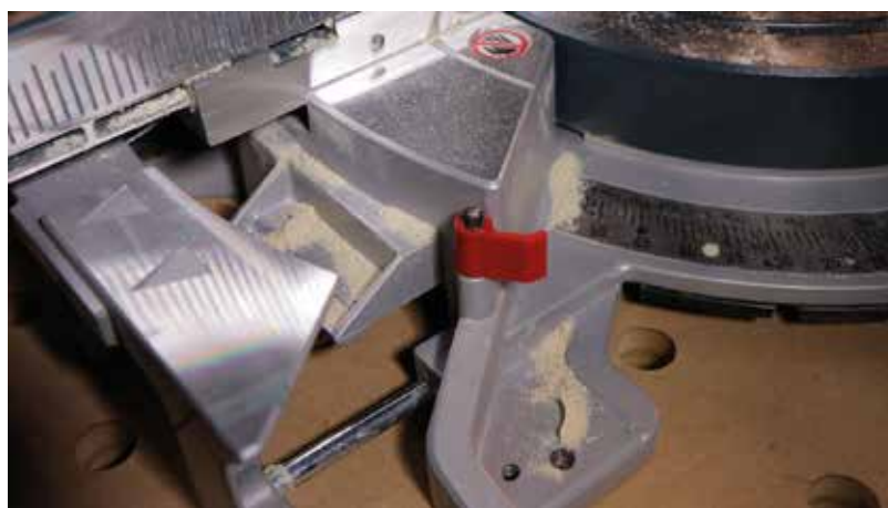
Az asztalhosszabbítóval ennél nagyobbra növelhetjük a munkaterületet.
