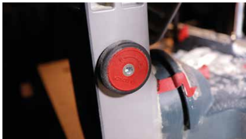
Szerelőkulcs és szerszám nélküli lapcseréhez mellékelt rögzítőcsavar.
