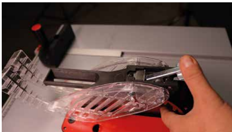
Gyorsan. Szerszám nélkül helyezhető fel a védősisak.
