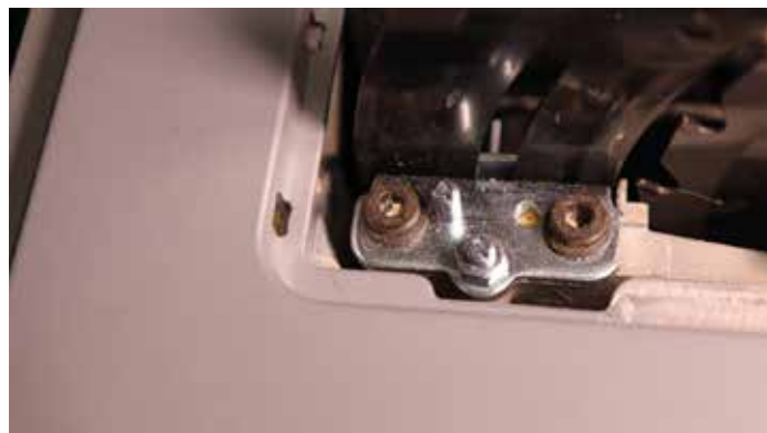
Kevés gépen van ennyi korrekciós lehetőség a hasítóék beállítására.
