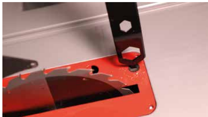
Kevés gépen van ennyi korrekciós lehetőség a hasítóék beállítására.
