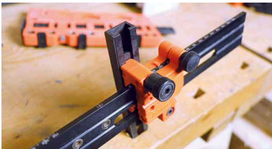
A „csonkított” botsablón a helyszíni szerelés nélkülözhetetlen sablonja lehet.
