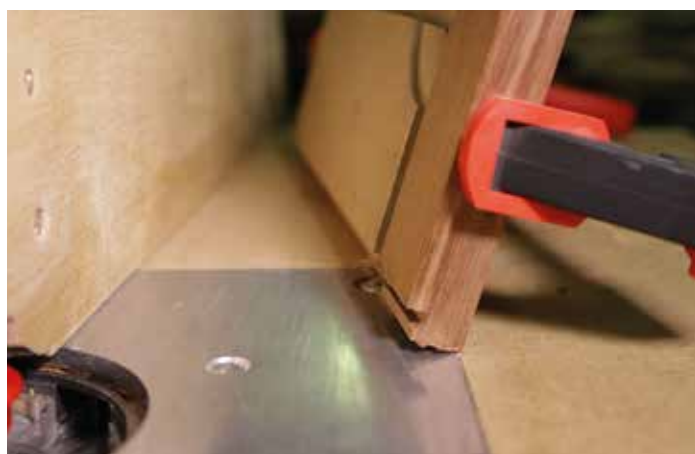
Keskeny alkatrészek esetében tolófát és rögzítést is kell alkalmaznunk.
