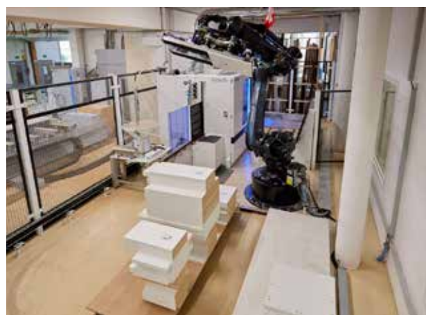
A Homag DRILLTEQ V-500 és a FEEDBOT D-300 kombinációjával összeállított automata megmunkálócella működés közben (Bantli AG, Svájc).
