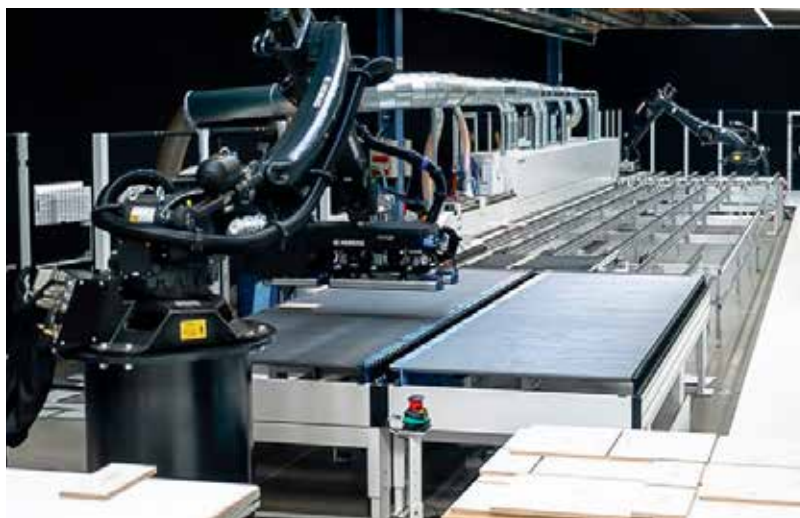
Élzáró gép adagolás és elszedés robotokkal.
