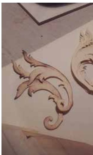
Nagy-Magyarország koronás címerének felragasztás utáni körbevágása intarziavágó géppel.
