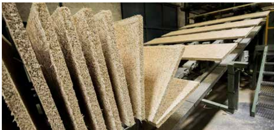
A Heraklith fagyapot lemezek a minőségükről, a kiváló hő- és hangszigetelő tulajdonságaikról, a kiemelkedő tűzállóságukról, tartósságukról és környezetbarátságukról ismert. Mi mégis azért szeretjük leginkább, mert fából van! (knaufinsulation.ch)
