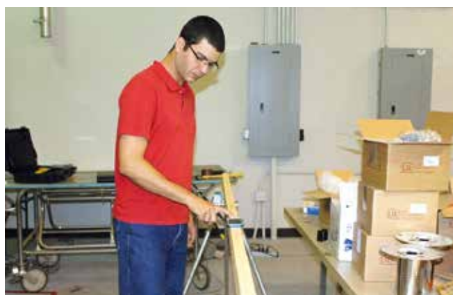
► Mobiltelefon alkalmazása fűrészáru rezgéseinek a mérésére (Franca és társai, a szerzők engedélyével).
