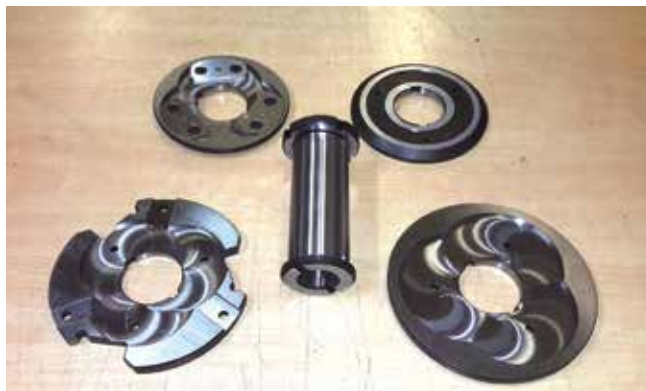
► Körkéses befogófejek kevés számú alkatrészei, ami esztergályozással termelékenyen gyárthatók
