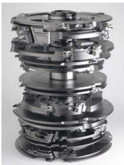
► Sok marási munkát igénylő profilkövető cserelapkás szerszám
