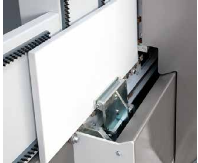
► Az alkatrészek állva kerülnek a fúróautomatába
