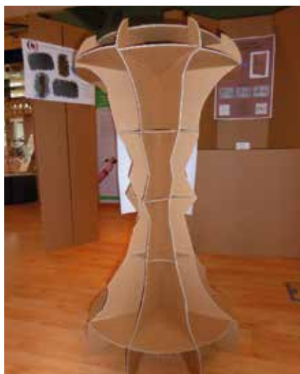
► „Almacsutka” posztamens. A prototípus felső lapja 240 N eloszló terheléssel lett tesztelve. Pupp Dávid alkotása
